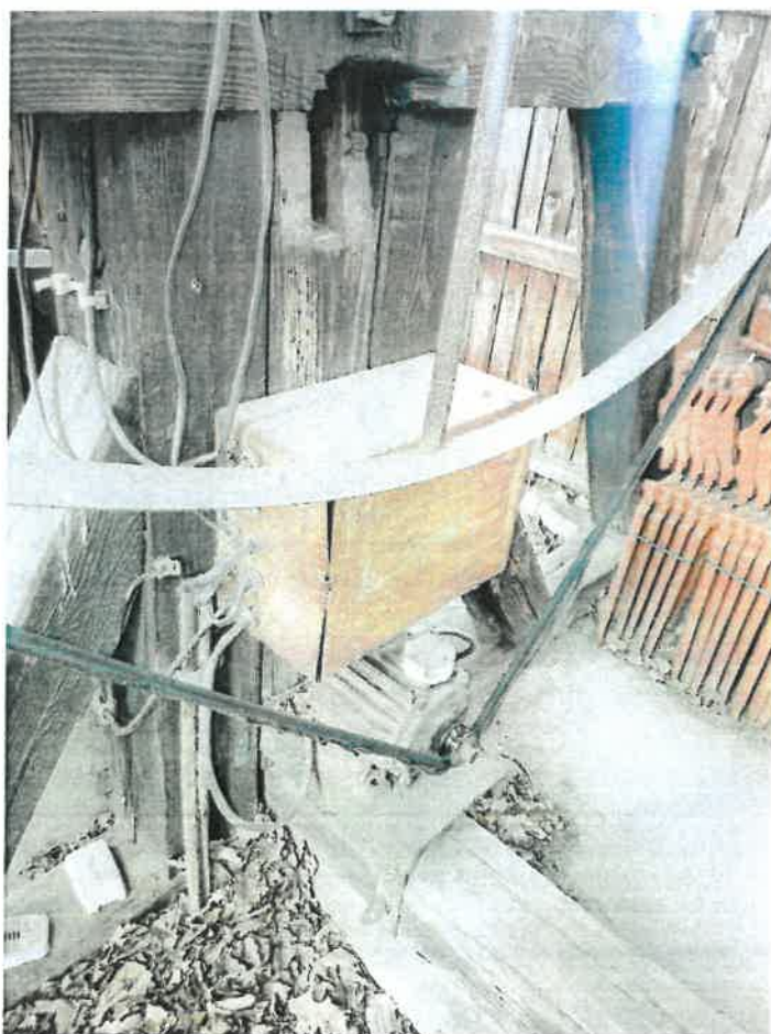
Fot. 4. Półkola napędowe.
